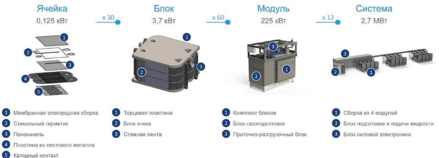
Рис. 1. Устройство SOEC-электролизера HYLINK SOEC производства Sunfire GmbH, Германия
