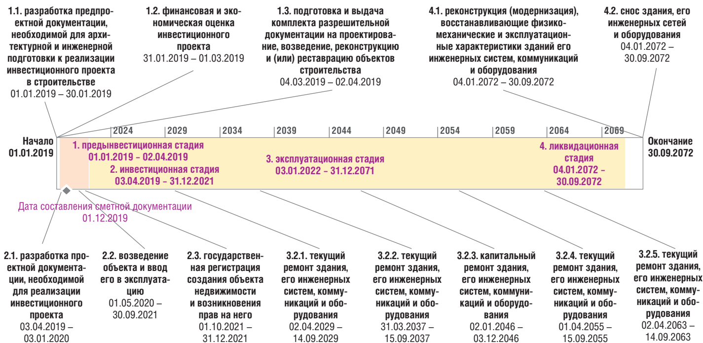
Рис. 1. Временная шкала жизненного цикла комплекса односекционных жилых домов серии М111-90 ОАО «МАПИД» в г. Минск
