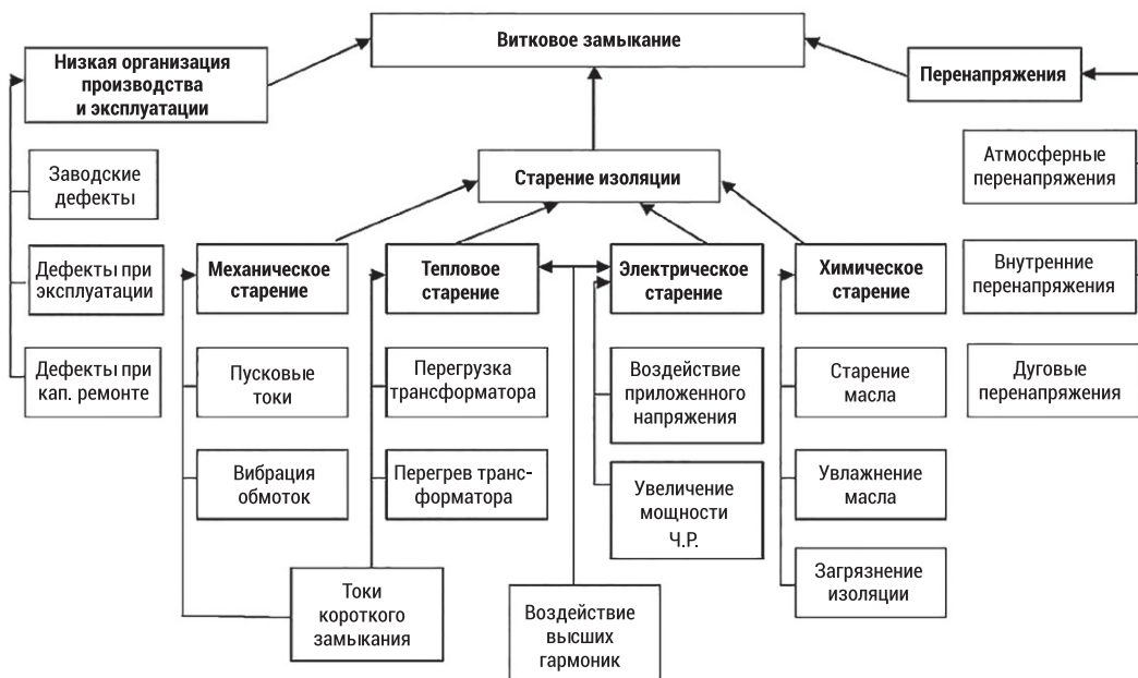
Рис. 1. Классификация факторов, влияющих на возникновение межвитковых замыканий трансформаторов
