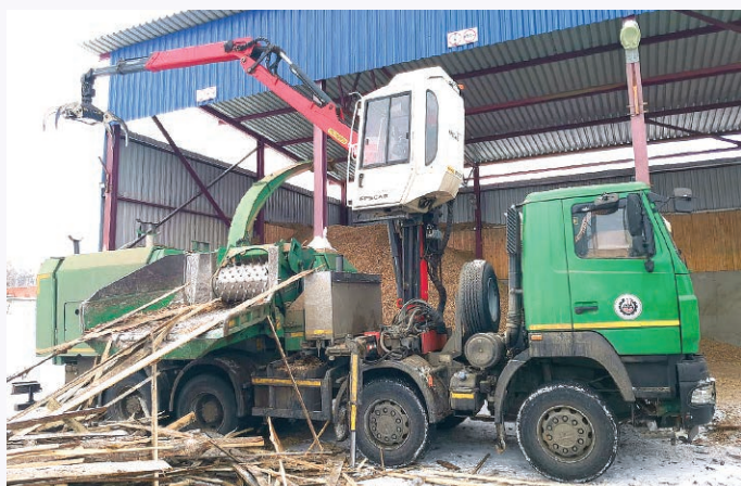
Работа щеподробильного комплекса JENZ на базе автомобиля MAZ
