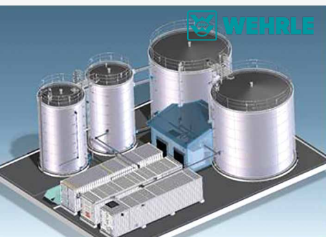
Рис. 4. Модель очистных сооружений для навоза производительностью 300 м³/сут
