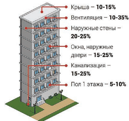
Рис. 6. Схема потерь тепловых ресурсов в зданиях низкого класса E_{h, hw} и ниже по энергоэффективности
