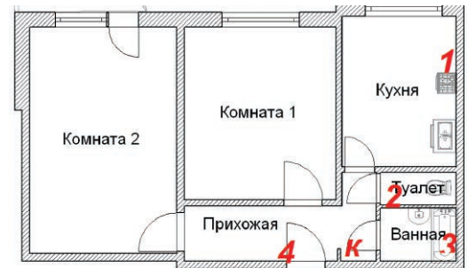
Рис. 4. Примерная схема установки датчиков (1 – датчик повышения температуры, 2 – датчик выключения света, 3 – датчик влаги, 4 – датчик открывания двери, К – главный блок «Кузя»)
